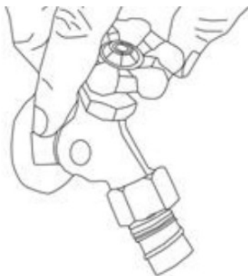
FIG. 10 — Abertura da torneira de alimentação
