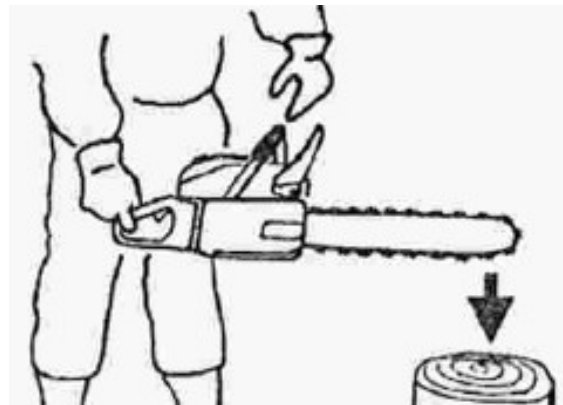
FIG. 15 — Verificação do travão de corrente
