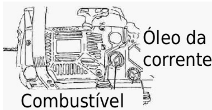
FIG. 6 — Tampões do depósito de combustível e do depósito de óleo da corrente
