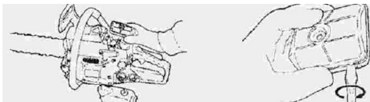
FIG. 21 — Limpeza do filtro de ar
