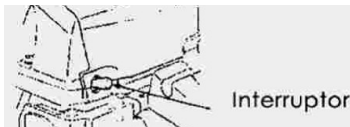
FIG. 7 — Interruptor de ignição
