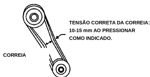
FIG. 7 — Tensão da correia trapezoidal
