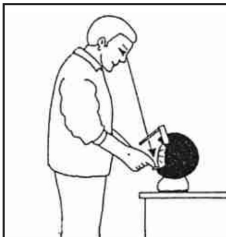
FIG. 4 — Ensaio do som da mó
