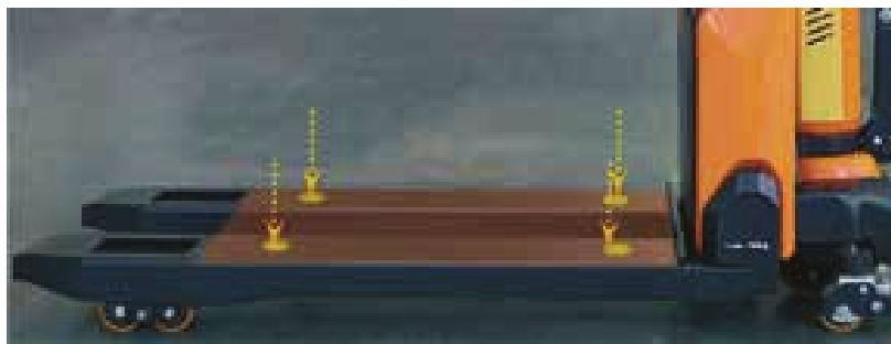
FIG. 12 — Localização das quatro células de carga no bastidor.
