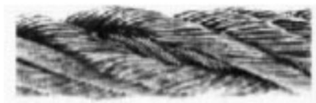
FIG. 14.3 — Grave defeito localizado com saída dos cabos interiores dos cordões, devido a repetidos solavancos. Este estado exige a substituição imediata.
