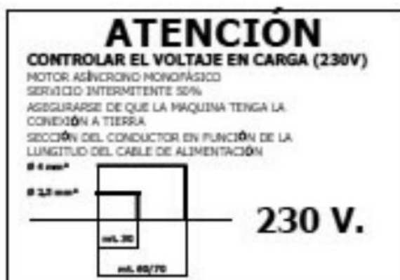
FIG. 10 — Chapa de advertência: controlo da tensão em carga e secção do condutor
