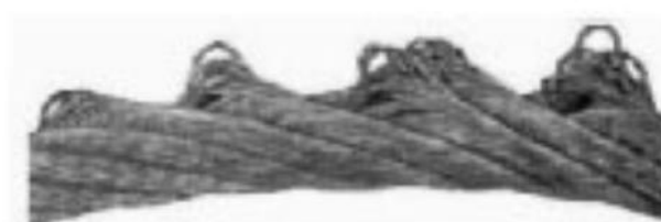
FIG. 14.2 — Grave desgaste e número notável de fios rotos. Atrito sob tensão sobre aresta viva. Este estado exige a substituição imediata.
