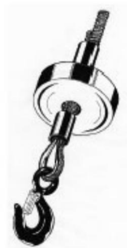
FIG. 15 — Fixação do cabo com casquilhos de alumínio
