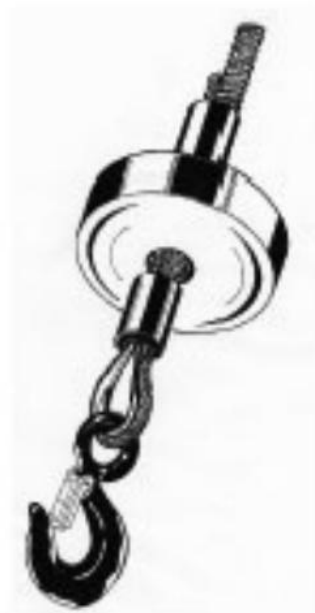
FIG. 15 — Fixação do cabo com casquilhos de alumínio
