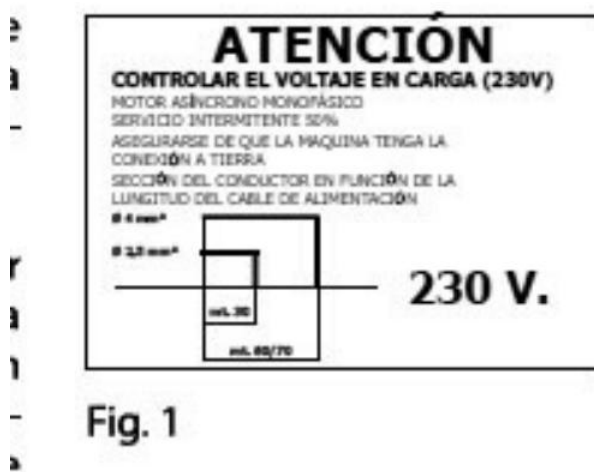
FIG. 10 — Chapa de advertência: controlo da tensão em carga e secção do condutor
