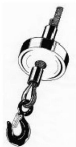
FIG. 15 — Fixação do cabo com casquilhos de alumínio
