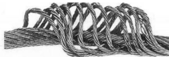
FIG. 7.5 — Empolamento causado por rotação forçada devida a gargantas demasiado estreitas ou a ângulo de desvio excessivo. Este estado exige a substituição imediata.
