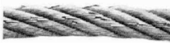
FIG. 7.1 — Rotura de fios em vários cordões adjacentes de um mesmo cabo com enrolamento cruzado (garganta da roldana demasiado estreita). Este estado exige a substituição.
