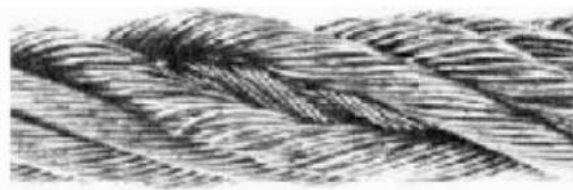
FIG. 7.4 — Alma do cabo a descoberto, com aumento local do diâmetro devido à abertura. Este estado exige a substituição.
