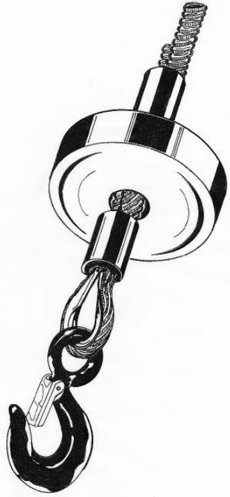
FIG. 8 — Fixação do cabo com casquilhos de alumínio
