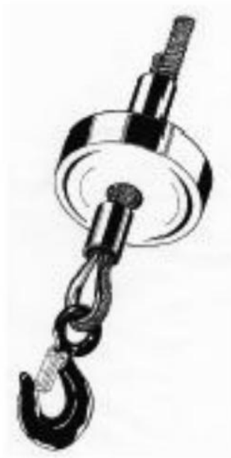
FIG. 15 — Fixação do cabo com casquilhos de alumínio
