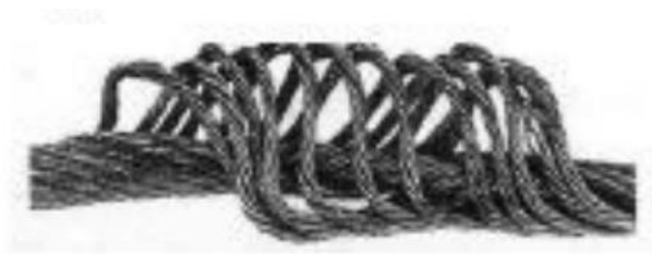
FIG. 14.5 — Empolamento causado por rotação forçada devida a gargantas demasiado estreitas ou a ângulo de desvio excessivo. Este estado exige a substituição imediata.
