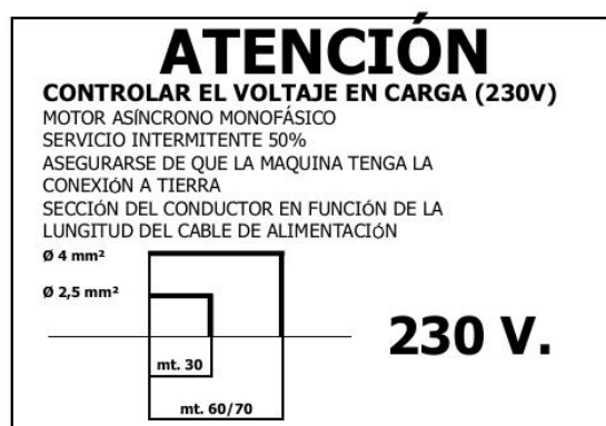
FIG. 5 — Chapa de advertência: controlo da tensão em carga e secção do condutor
