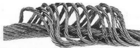
FIG. 9.5 — Empolamento causado por rotação forçada devida a gargantas demasiado estreitas ou a ângulo de desvio excessivo. Este estado exige a substituição imediata.
