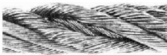
FIG. 9.4 — Alma do cabo a descoberto, com aumento local do diâmetro devido à abertura. Este estado exige a substituição.
