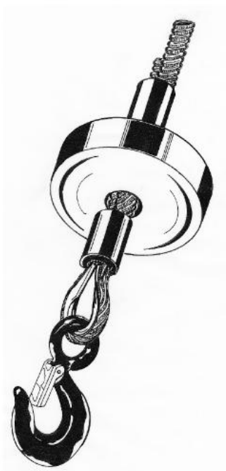
FIG. 10 — Fixação do cabo com casquilhos de alumínio
