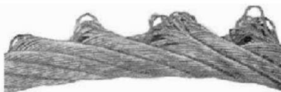
FIG. 9.3 — Grave defeito localizado com saída dos cabos interiores dos cordões, devido a repetidos solavancos. Este estado exige a substituição imediata.
