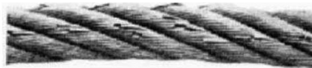
FIG. 9.1 — Rotura de fios em vários cordões adjacentes de um mesmo cabo com enrolamento cruzado (garganta da roldana demasiado estreita). Este estado exige a substituição.
