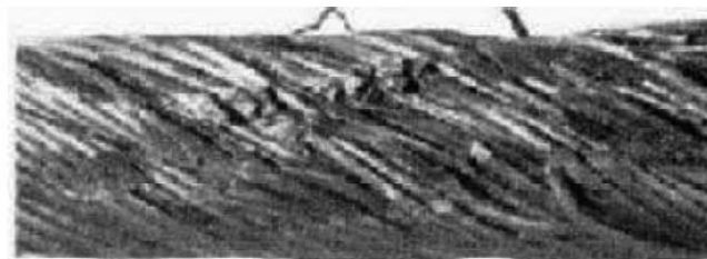
FIG. 9.2 — Desgaste grave e número notável de fios partidos. Atrito sob tensão sobre aresta viva. Este estado exige a substituição imediata.
