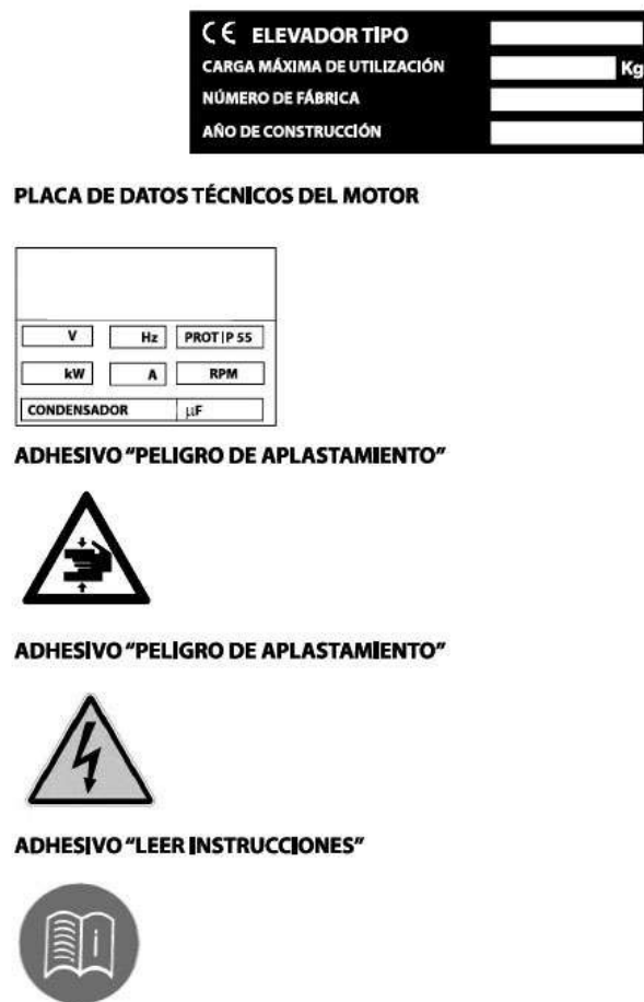
FIG. 2 — Placas e autocolantes presentes no elevador
