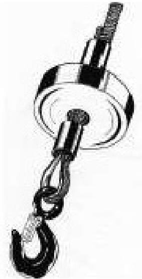
FIG. 11 — Fixação do cabo com casquilhos de alumínio
