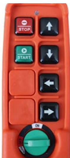
Comando sem fios: STOP, START, SUBIR/BAIXAR (elevação), ESQUERDA/DIREITA (carro) e chave ON/OFF
