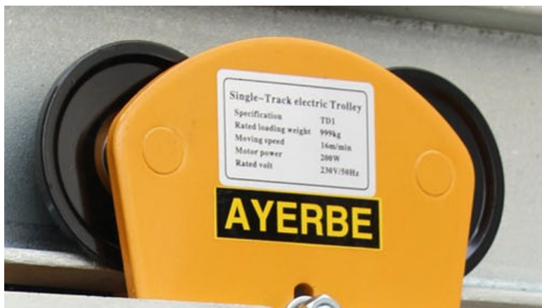
Carro elétrico monocarril (electric trolley TD1)
