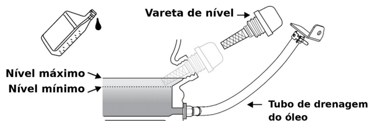
FIG. 7 — Enchimento e verificação do nível de óleo
