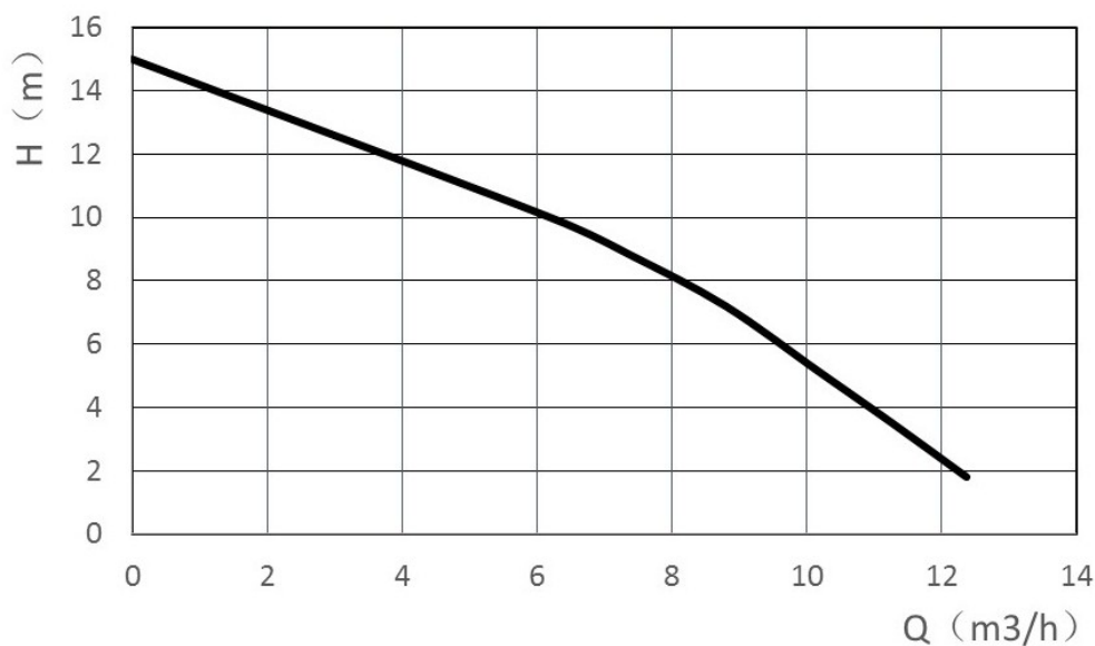
FIG. 2 — AY-40 KT: curva caudal-altura
