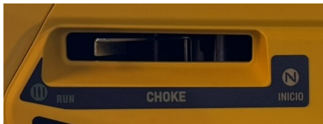
FIG. 4 — Commande du starter : positions RUN et INICIO
