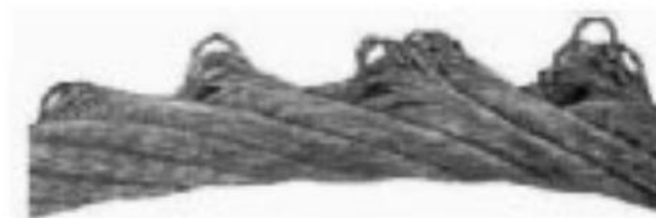
FIG. 14.2 — Usure importante et nombre notable de fils rompus. Frottement sous tension sur arête vive. Cet état exige le remplacement immédiat.
