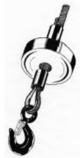
FIG. 15 — Fixation du câble par manchons en aluminium
