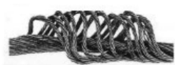
FIG. 14.4 — Âme du câble à découvert, avec augmentation locale du diamètre due à l'ouverture. Cet état exige le remplacement.
