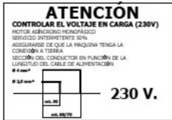
FIG. 10 — Plaque d'avertissement : contrôle de la tension en charge et section du conducteur
