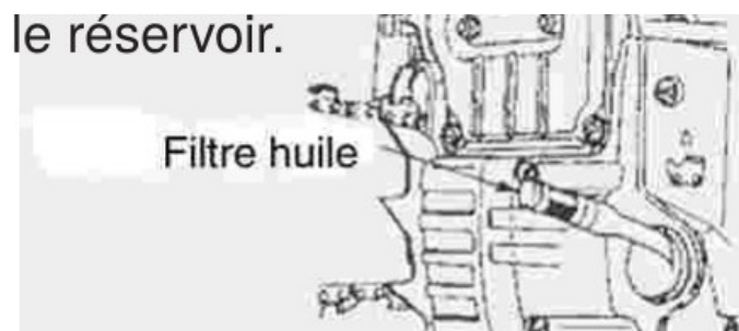
FIG. 26 — Extraction du filtre à huile
