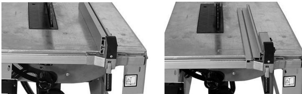
FIG. 7 — Guide parallèle : chant large (a) et chant étroit (b)
