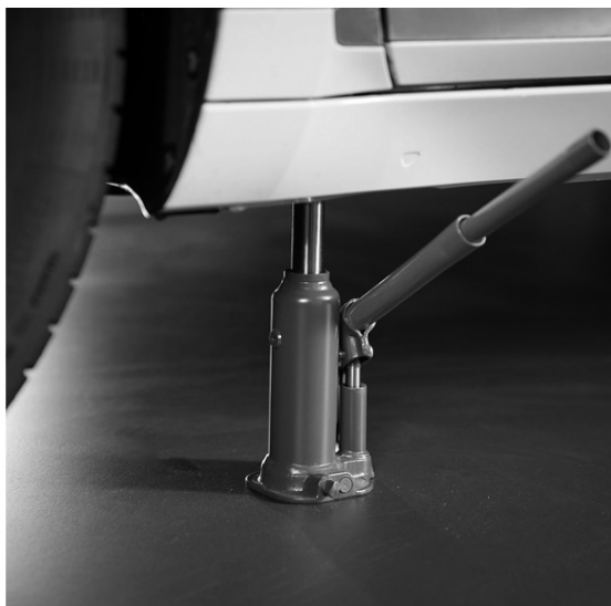
FIG. 2 — Levage d'un véhicule par son point d'appui
