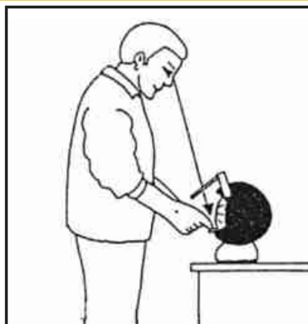
FIG. 4 — Essai sonore de la meule
