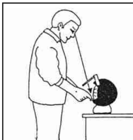
FIG. 4 — Essai sonore de la meule
