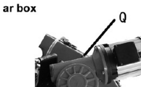
FIG. 17 — Réducteur : bouchons de vidange (O), de purge (P) et de remplissage (Q)
