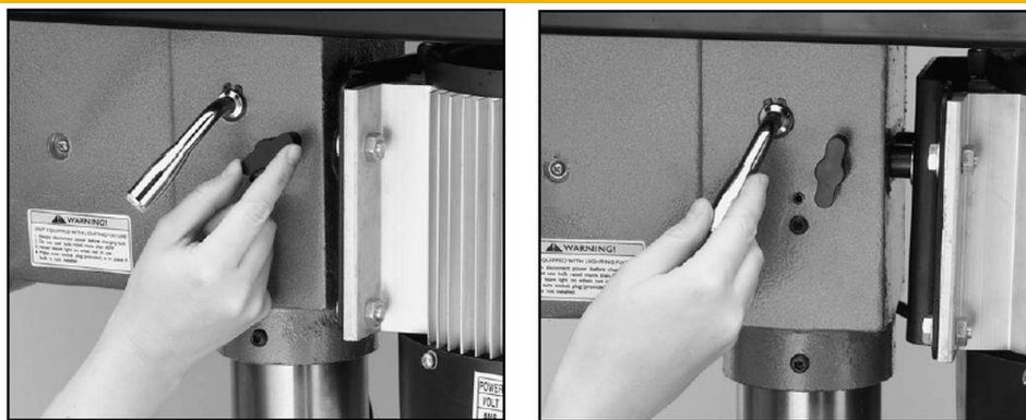
FIG. 10 — Manettes de blocage et levier de tension des courroies
