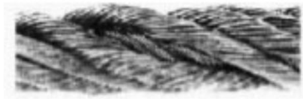
FIG. 14.3 — Défaut localisé grave avec sortie des câbles intérieurs des torons, dû à des à-coups répétés. Cet état exige le remplacement immédiat.
