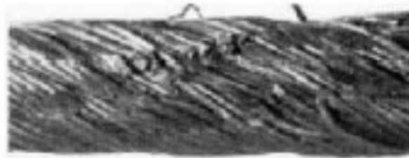
FIG. 14.1 — Rupture de fils dans plusieurs torons adjacents d'un même câble à enroulement croisé (gorge de poulie trop étroite). Cet état exige le remplacement.
