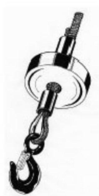
FIG. 15 — Fixation du câble par manchons en aluminium
