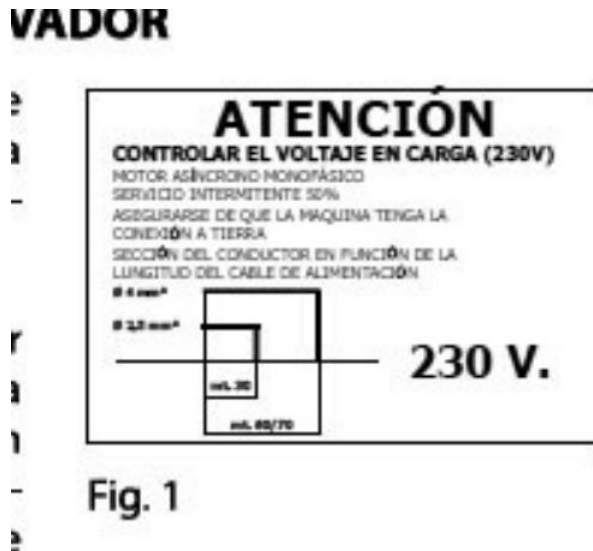
FIG. 10 — Plaque d'avertissement : contrôle de la tension en charge et section du conducteur
