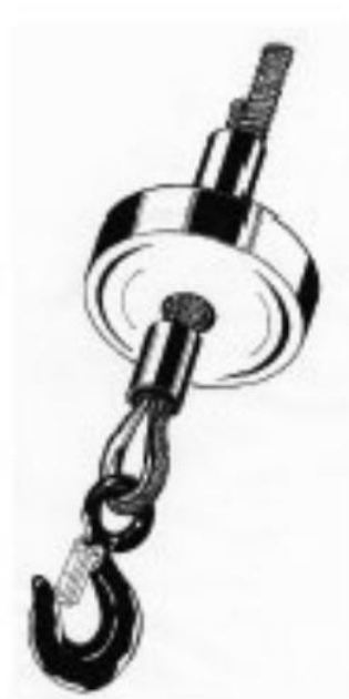
FIG. 15 — Fixation du câble par manchons en aluminium
