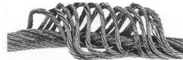
FIG. 7.5 — Renflement causé par une rotation forcée due à des gorges trop étroites ou à un angle de déviation excessif. Cet état exige le remplacement immédiat.
