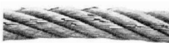
FIG. 7.1 — Rupture de fils dans plusieurs torons adjacents d'un même câble à enroulement croisé (gorge de poulie trop étroite). Cet état exige le remplacement.
