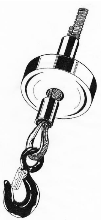
FIG. 8 — Fixation du câble par manchons en aluminium
