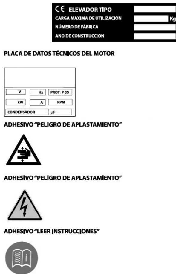
FIG. 2 — Plaques et autocollants présents sur l'élévateur
