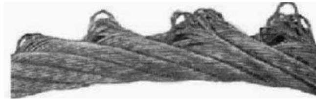
FIG. 9.3 — Défaut grave localisé avec sortie des câbles intérieurs des torons, causé par des à-coups répétés. Cet état exige le remplacement immédiat.
