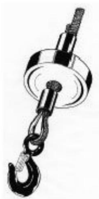
FIG. 15 — Fixation du câble par manchons en aluminium
