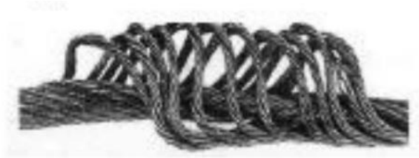
FIG. 14.5 — Renflement causé par une rotation forcée due à des gorges trop étroites ou à un angle de déviation excessif. Cet état exige le remplacement immédiat.
