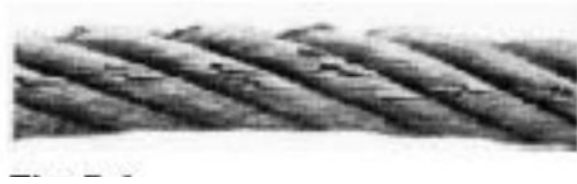
FIG. 14.1 — Rupture de fils dans plusieurs torons adjacents d'un même câble à enroulement croisé (gorge de poulie trop étroite). Cet état exige le remplacement.
