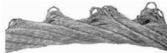
FIG. 9.3 — Défaut localisé grave avec sortie des câbles intérieurs des torons, dû à des à-coups répétés. Cet état exige le remplacement immédiat.
