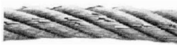
FIG. 9.1 — Rupture de fils dans plusieurs torons adjacents d'un même câble à enroulement croisé (gorge de poulie trop étroite). Cet état exige le remplacement.
