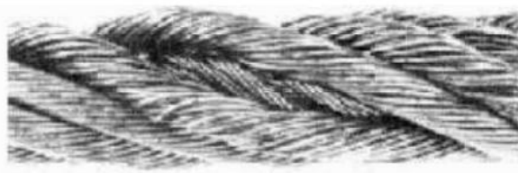
FIG. 9.4 — Âme du câble à découvert, avec augmentation locale du diamètre due à l'ouverture. Cet état exige le remplacement.
