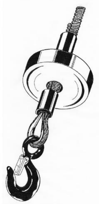
FIG. 10 — Fixation du câble par manchons en aluminium
