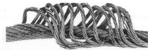
FIG. 9.5 — Renflement causé par une rotation forcée due à des gorges trop étroites ou à un angle de déviation excessif. Cet état exige le remplacement immédiat.
