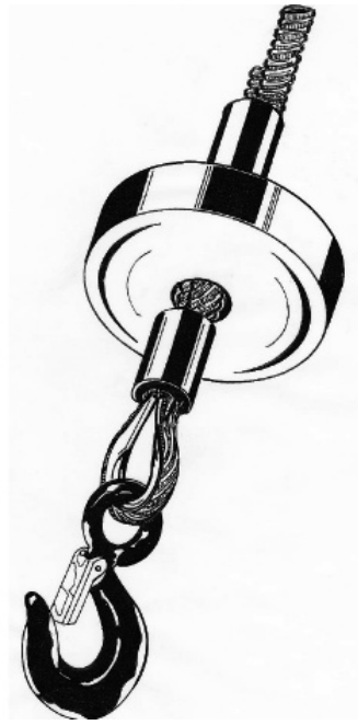
FIG. 12 — Fixation du câble avec manchons en aluminium
