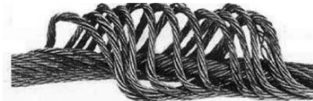
FIG. 9.5 — Renflement causé par une rotation forcée due à des gorges trop étroites ou à un angle de déviation excessif. Cet état exige le remplacement immédiat.
