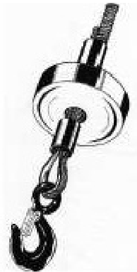
FIG. 11 — Fixation du câble avec manchons en aluminium
