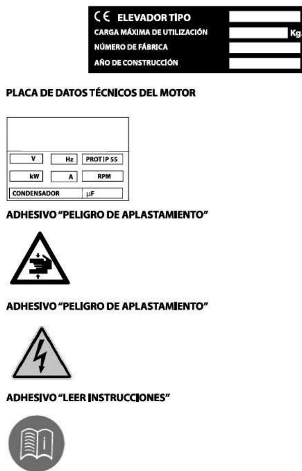
FIG. 2 — Plaques et autocollants présents sur l'élévateur
