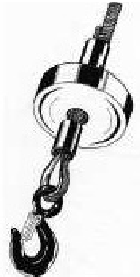
FIG. 11 — Fixation du câble avec manchons en aluminium
