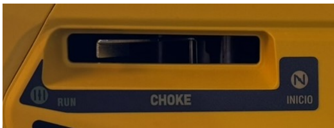
FIG. 4 — Mando del estérter: posiciones RUN y INICIO
