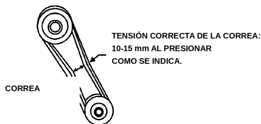
FIG. 7 — Tensión de la correa trapezoidal
