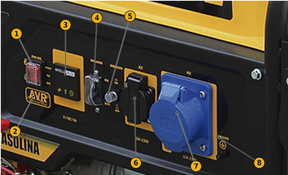
FIG. 5 — Cuadro de mandos del AY 5500 E (cód. 5434170). El AY 5500 (cód. 5434165) es idéntico, con conmutador de dos posiciones ON / OFF y sin arranque eléctrico
