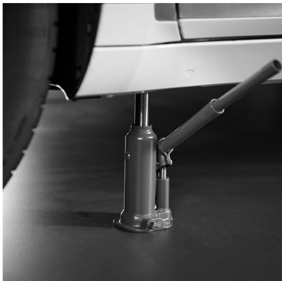
FIG. 2 — Elevación de un vehículo por su punto de apoyo
