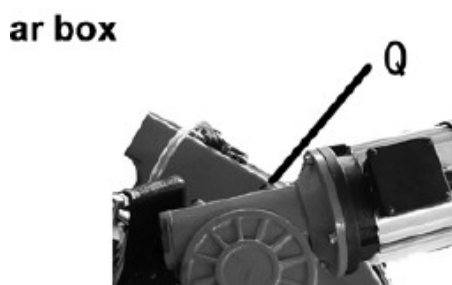
FIG. 17 — Reductor de engranajes: tapones de vaciado (O), de drenaje (P) y de llenado (Q)
