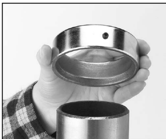
FIG. 5 — Anillo de retención de la cremallera
