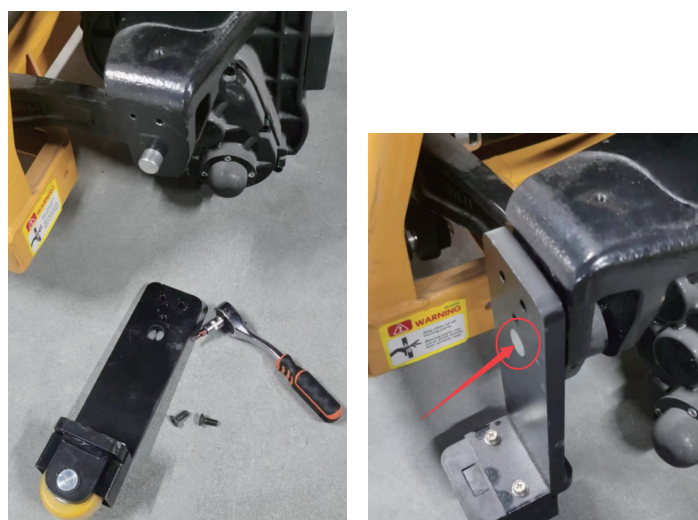
FIG. 16 — Preparación de los componentes (izquierda) y alineación con el eje del chasis (derecha).
