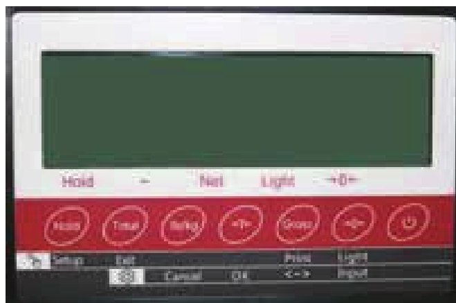
FIG. 11 — Panel de mandos del terminal de pesaje.
