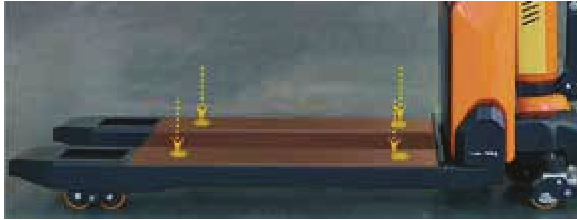
FIG. 12 — Situación de las cuatro células de carga en el bastidor.
