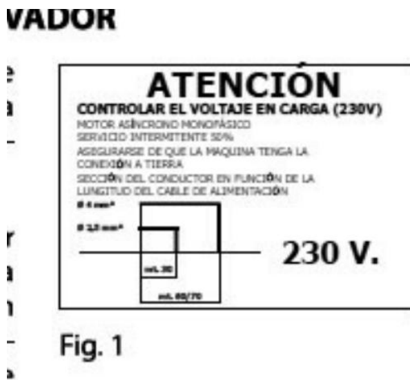
FIG. 10 — Placa de advertencia: control del voltaje en carga y sección del conductor
