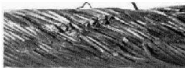
FIG. 9.2 — Grave desgaste y número notable de hilos rotos. Rozamiento bajo tensión sobre arista viva. Dicho estado requiere la sustitución inmediata.
