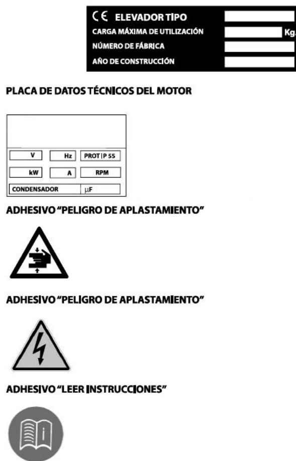
FIG. 2 — Placas y adhesivos presentes en el elevador
