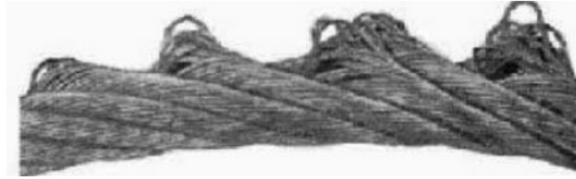
FIG. 9.3 — Grave defecto localizado con salida de los cables interiores de los haces, a causa de repetidos tirones. Dicho estado requiere la sustitución inmediata.
