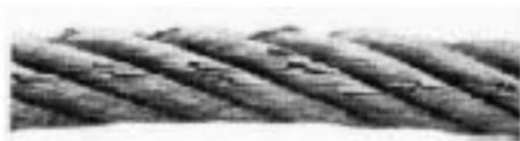
FIG. 14.1 — Rotura de hilos en varios haces adyacentes de un mismo cable con enrollamiento cruzado (garganta de la polea demasiado estrecha). Dicho estado requiere la sustitución.
