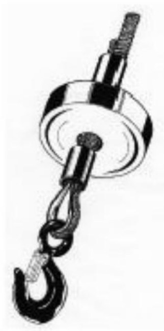
FIG. 15 — Fijación del cable con manguitos de aluminio
