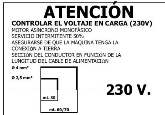
FIG. 5 — Placa de advertencia: control del voltaje en carga y sección del conductor
