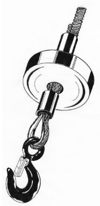
FIG. 10 — Fijación del cable con manguitos de aluminio
